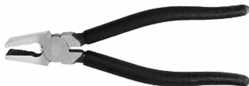
32 133 00 PROVETRO - lámací kleště PCJ-4, šíře lámacích čelistí 22 mm, použití pro lámání dlouhých tenkých proužků skla, odlamování ze strany, určené pro sílu skla 2 - 12 mm
